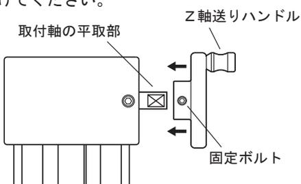
④ Z方向スライドボルトを締めZ軸送りハンドルを回しながら動きの調整を行ってください。
