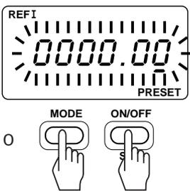
⑧ 基準値を入力後MODEキーを“MM”と“SET”モードが表示されるまで押し、表示した瞬間にキーを放します。
