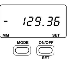
⑫SETキーを押すと入力した基準値が表示され“SET”表示が一瞬点滅した瞬間にキーを離します。
