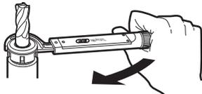
Ziehen Sie die Spannmutter an, bis der Drehmomentschlüssel klickt.
