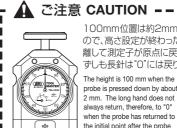
100mm位置は約2mm圧縮時な ので、高さ設定が終わった後、指を 離して測定子が原点に戻った時、必 ずしも長針は"O"には戻りません。
