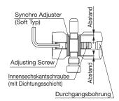
(3) Am Schluss muss der kleine Abstand zwischen der MGT Set Schraube und dem Synchro Adjuster durch Festziehen der Einstellschraube auf Null eingestellt werden. Setzen Sie die MGT Set Schraube in die Bohrung des Synchro Adjusters und drehen Sie die Einstellschraube sorgfältig, bis die MGT Set Schraube durch das Eigengewicht nicht mehr nach unten fällt. Ziehen Sie danach die Einstellschraube zur Vorspannung des Synchro Adjusters um weitere 90° fest.
