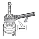
Bringen Sie den MEGA WRENCH Rollen-Schlüssel (Optional) über die Mutter bis zum Anschlag an, so dass die mit "OPEN" markierte Seite nach oben gerichtet ist. Lösen Sie die Mutter und den Gewindebohrer durch Drehen des Schlüssels in die gezeigte Pfeilrichtung.
