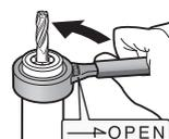
※ 将美夹扳手套装到螺母上时,沿扳手上箭头的反方向边转动边往螺母上套比较容易套上。
