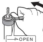
※Für eine leichtere Anwendung des MEGA WRENCH Rollenschlüssels wird empfohlen, die Spannmutter beim Aufschieben ein Stück zurückzudrehen.
