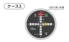
①電源ON後、XY軸のどちらかが 水平レベル0.08を超えている場合。 LED(赤)点滅
