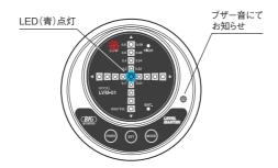
⑥MODE切替えスイッチで **HIGH** モードに切替えて ください。
