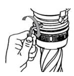
万が一、締付ナットをゆるめても刃具が抜け ないときは、回り止めピンを回して下さい。
