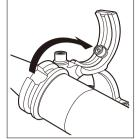
3.レバーを切り欠け部より外し、 ホルダをロックします。 この時、ピンがバネによって 飛び出してきますので、ホル ダとの隙間で手を挟まないよ うご注意ください。
