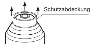
2. Drehen und entfernen Sie den Batterieverschluss mit einer Münze oder einem ähnlichen Gegenstand und legen Sie die 2 Batterien (SR44) wie rechts abgebildet ein und ziehen Sie den Verschluss fest. Bei umgekehrter Ausrichtung leuchtet der LEUCHTRING nicht auf.
